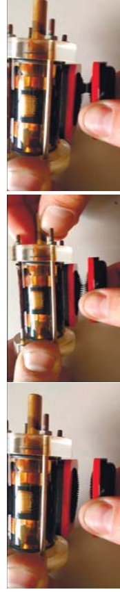
Рис.3-Реакція ФМР на магнітне поле від зазору магніту: а- зазор магнітного поля 14 мм; б- зазор магнітного поля 10 мм; в- зазор магнітного поля 6 мм.
